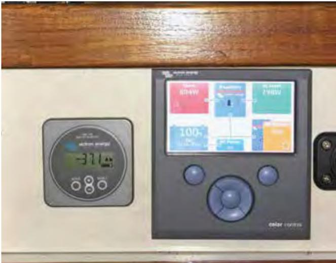
El MultiPlus y el Color Control GX forman realmente una sociedad perfecta y permiten un control y seguimiento total. Junto con una conexión a internet, ya no hay necesidad de preocuparse por el estado de la carga de las baterías, ya que puede dejar su barco en cualquier puerto y controlar el sistema a través de un smartphone o de un portátil.
